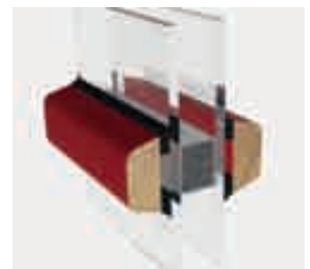
"Wiener" Sprosse mit beidseitig aufgeklebter Holz-Sprosse Breite: 15/18/24/30/36 mm
